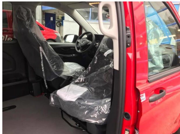
Foto: Førersetene vendes 180 °, vi monterer fast arbeidsbord bak førersetene for PC, kart etc.
